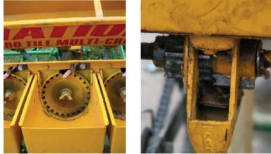
चित्र ३ बाँया-Fluted Seed meter दाँया-Inclined Plate Seed Meter
