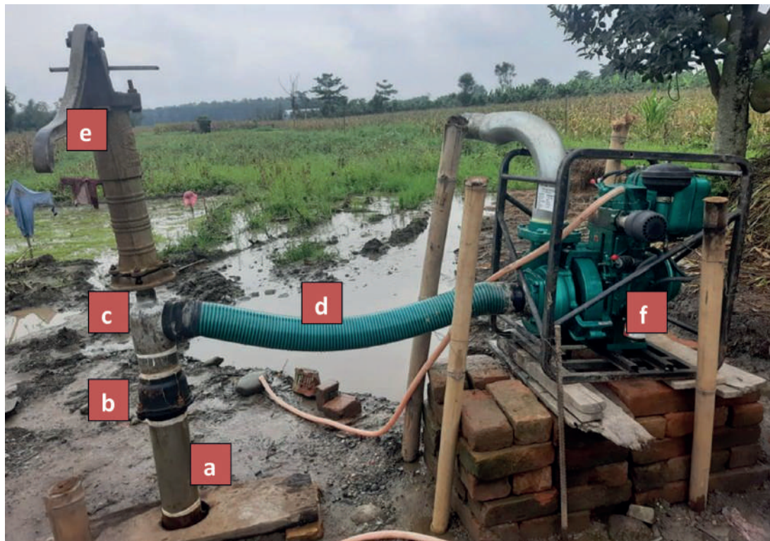
चित्र नं. ४ : (a) GI pipe, (b) Check valve, (c) T-bottle (d) suction pipe (e) handle (f) diesel engine
