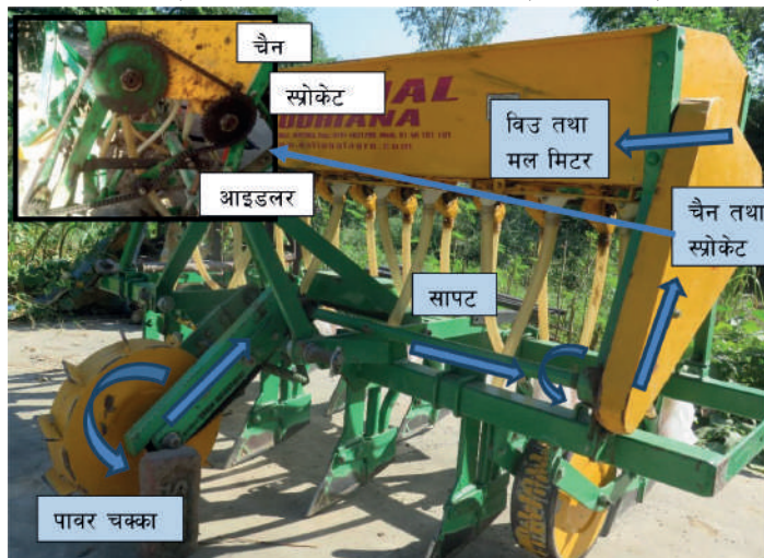
चित्र ४ सिडड्रिल चलाउने इकाइ अर्थात पावर प्रवाह एकाइ
