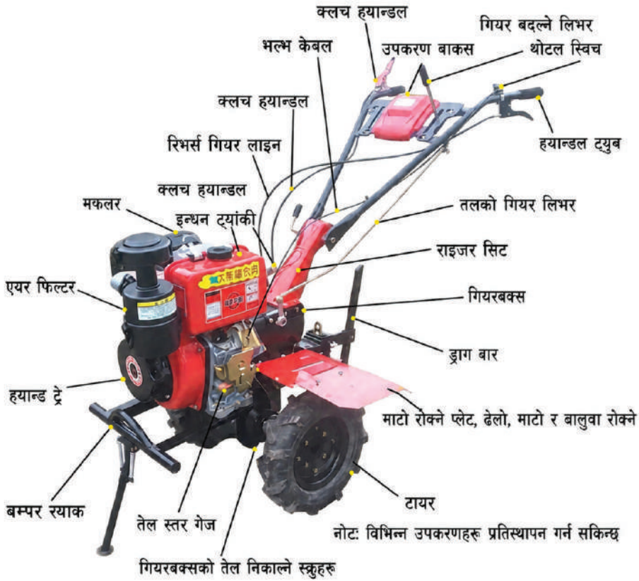
चित्र १. मिनी टिलरका प्रमुख भागहरू (Shanghai Yonghengsheng Industrial Co., Ltd, २०२६)
