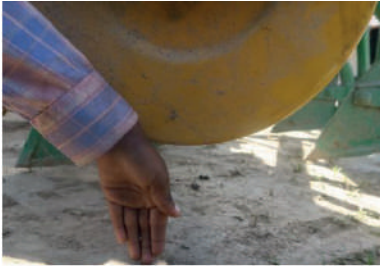
चित्र ५ गहिराई नियन्त्रण गर्ने चक्का र जमिन विचको दुरीनै मल विउ खस्ने गहिराइ रहन्छ।
