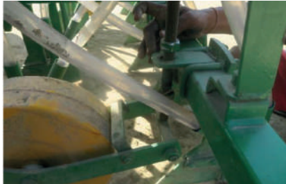
चित्र ६ : गहिराई नियन्त्रण गर्ने चक्कालाई नट र बेल्टको सहायताले जमिनबाट तल माथि गर्न सकिन्छ।
