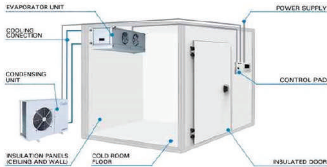
चित्र २: शीत भण्डारण कक्षका आन्तरिक तथा बाह्य भौतिक अवयवहरूको संरचनात्मक रूपरेखा
